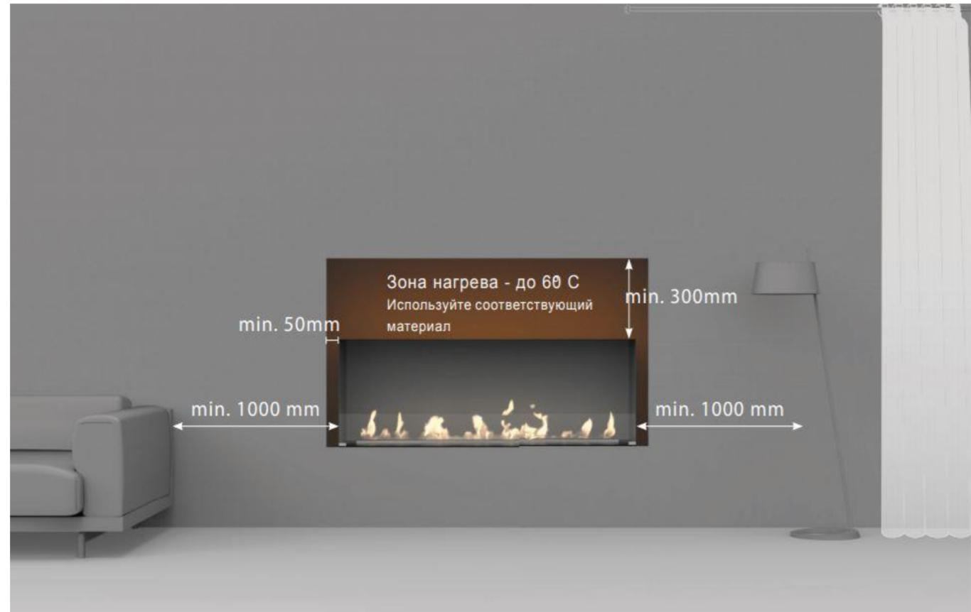
Ниша и опорные стойки слева и справа посадочного места под биокамин должны быть ровными (как вертикально, так и горизонтально) и все углы должны быть выполнены точно под углом 90°.
